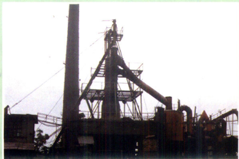
高桥磷肥厂生产钙 镁磷肥的主体设备—— 高炉
