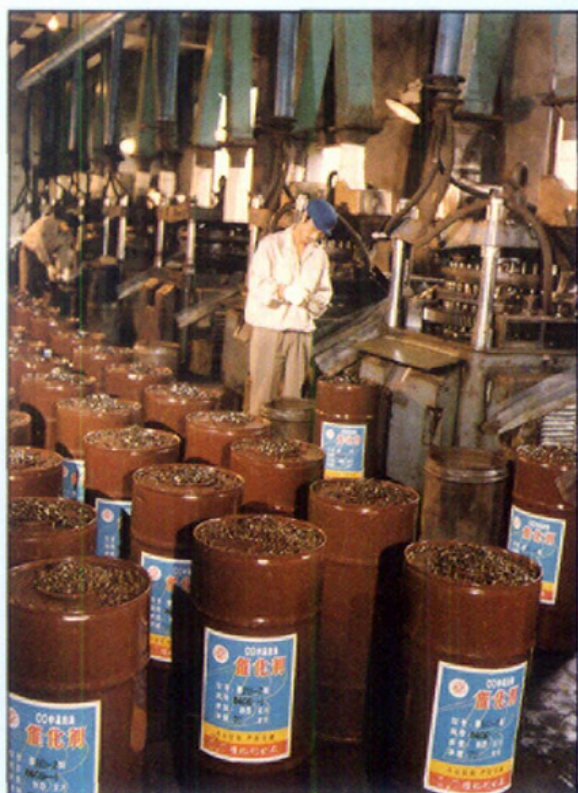
四川化工厂催化剂分厂 工人正在对中变催化剂进行 打片
