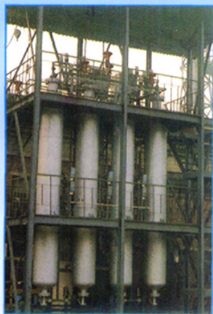
西南化工研究院研制的 500Nm 3 /时变压吸附中试装置
