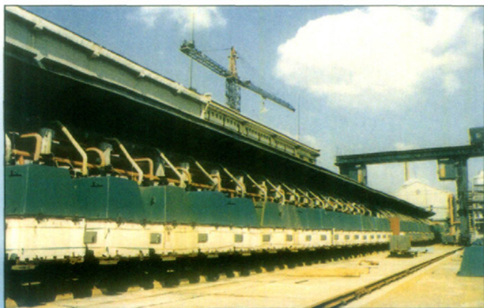
重庆天原化工厂金属阳极电解槽装置
