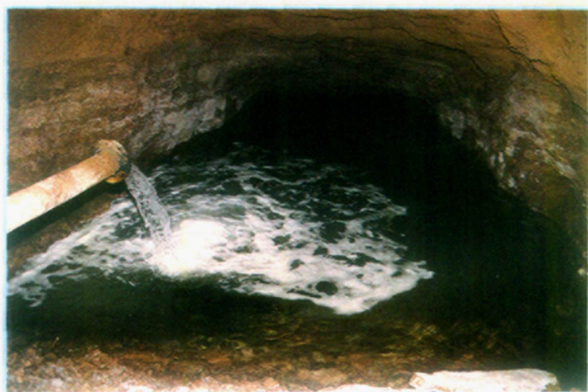
四川省芒硝矿首创的钙芒硝矿硐室水溶法浸取硝水
