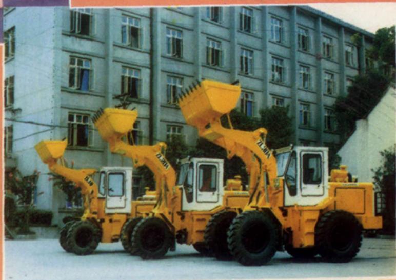
▲成都工程机械总厂 生产的 ZL10-20-30 液压 装载机
