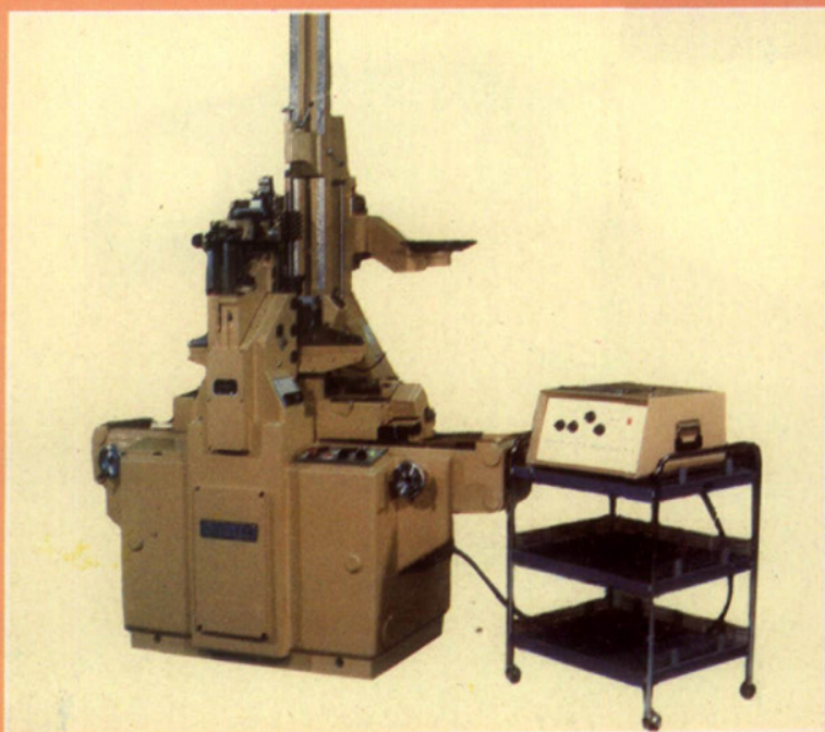
▲成都量具刃具厂生产的 GDY-300滚刀测量仪
