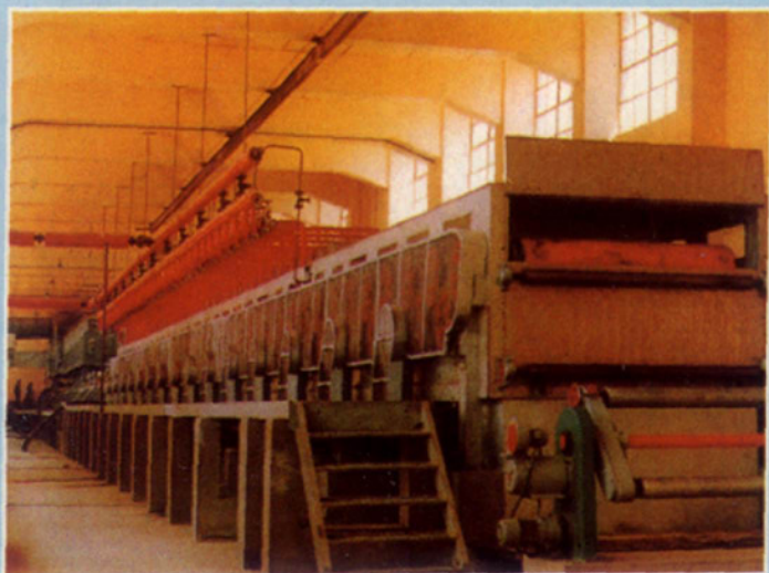
▲亚西机器厂生产的BN-1800玻璃纸成型机
