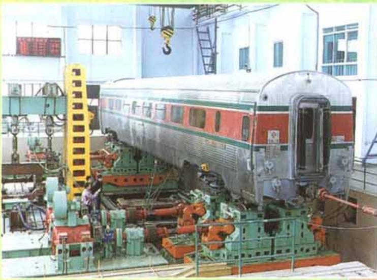
西南交通大学国家级牵引动力实验室正在对车辆性能进行实验鉴定
